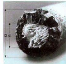
Section of actual decay part
